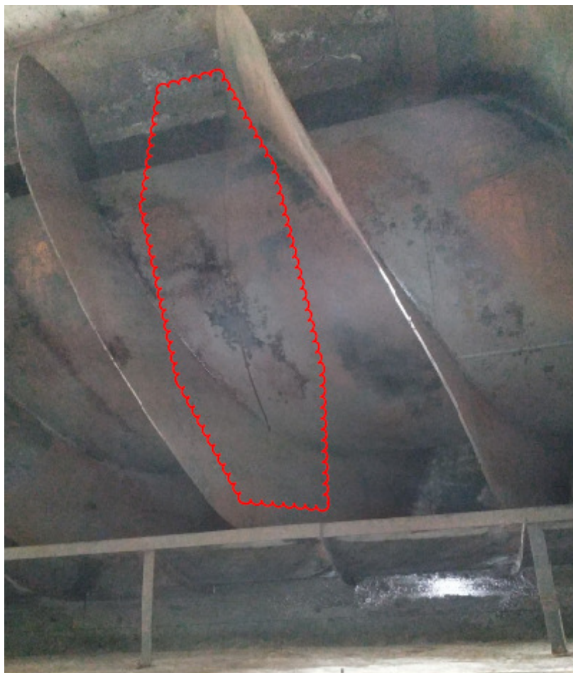
Zona del fusto coclea interessato dalla lesione
