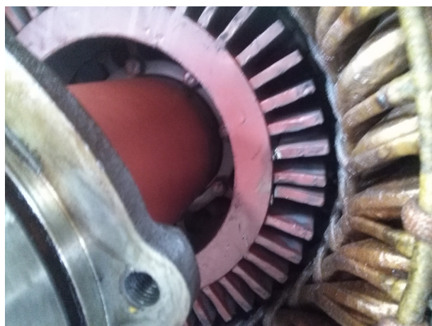
Particolare barre rotoriche dissaldate
