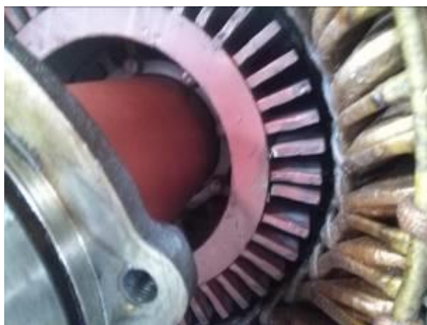
Particolare barre rotoriche dissaldate
