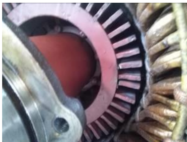
Particolare barre rotoriche dissaldate
