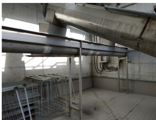
Particolare delle coclee esistenti
