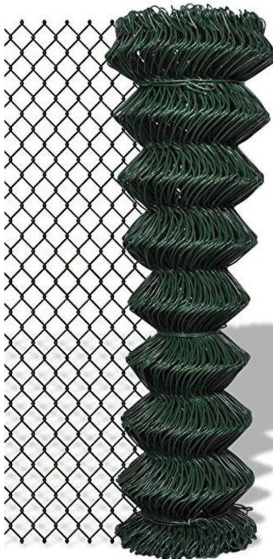
Rete metallica in acciaio plastificato a maglia romboidale - maglia: mm50x50 - filo 2,5 mm – H. 2,00 mt. – resistente a semplice torsione, conosciuta sul mercato anche con il nome di "maglia sciolta" "rete a rombi" o "rete griglia" , realizzata ad intreccio e non elettrosaldata.
