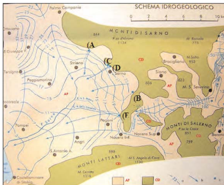
Figura 9 - Schema Idrogeologico della Piana del Fiume Sarno (da CELICO et alii, 1990). Legenda: AP) complesso alluvionale-piroclastico; CD) Complesso calcareo, calcareo dolomitico e dolomitico; (A) (E) Ubicazione sorgenti. - Hydrogeological map of F. Sarno Plain (from CELICO et alii, 1990). Legend: AP) alluvial-pyroclastic complex; CD) calcareous and calcareous dolomitic complex; (A) (E) Spring ubication.
